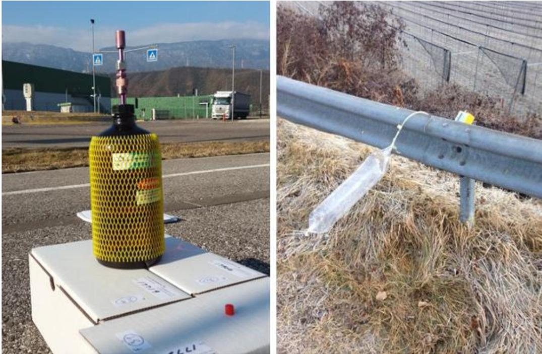
Figura 3.2: Bottiglia a tenuta con valvola a baionetta (sinistra) e sacchetto di Teflon con pompetta (destra). Le fotografie sono state scattate durante le prove con tracciate rispettivamente del 14 febbraio 2017 e del 27 gennaio 2016.
