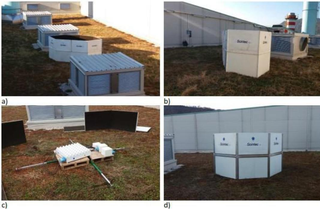
Figura B.5: Distorsione della struttura di pannelli fonoassorbenti a seguito di eventi intensi di Föhn (a, b). Rinforzo alla struttura dei pannelli fonoassorbenti del SODAR effettuata nel mese di novembre 2016: il supporto per l'antenna (c) e i rinforzi di alluminio applicati all'esterno dei pannelli (d).
