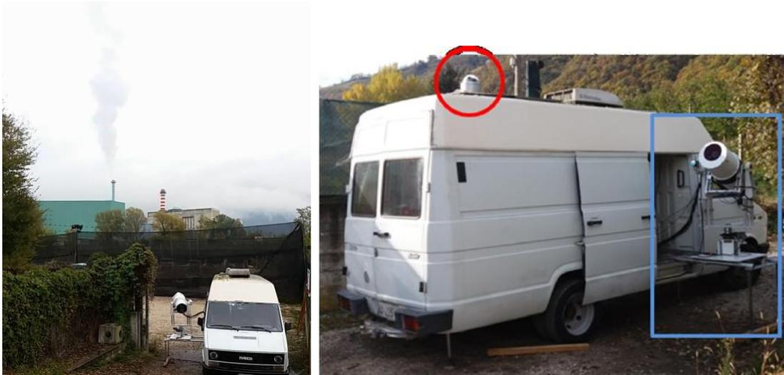
Figura C.1: Sito sperimentale e installazione della strumentazione per l'esecuzione delle campagne di misura (a sinistra). Dettaglio della strumentazione utilizzata (a destra). Nel cerchio rosso lo spettro-radiometro, nel rettangolo azzurro il LIDAR
